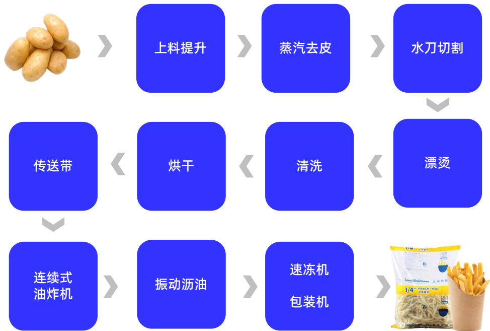
速冻食品生产流程（以速冻薯条为例）
