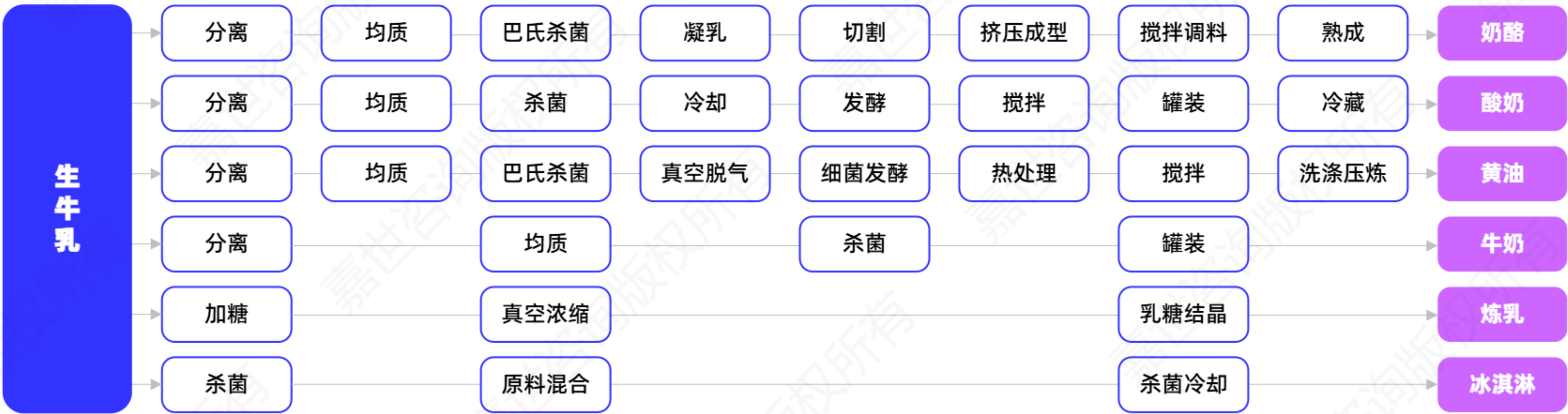
各种乳制品的加工制造流程
